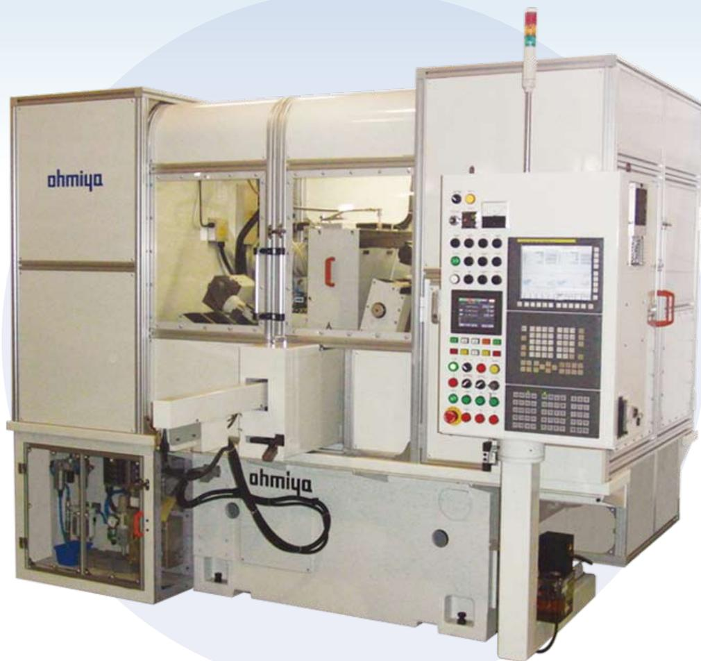
[ 切入式磨削，1次进给可以实现复杂形状工件的磨削加工 ]
