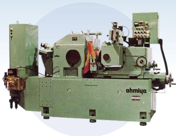
1. 研削といし軸・調整車軸とも超精密複列円筒コロ軸受けで支持され、軸受けの給油・冷却はオイルミスト装置で行っています。
