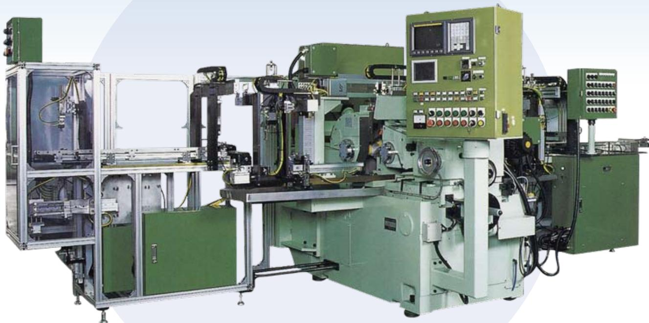
**[ 横向进给磨削，生产线对应型，两个工件同时磨削规格 ]**
