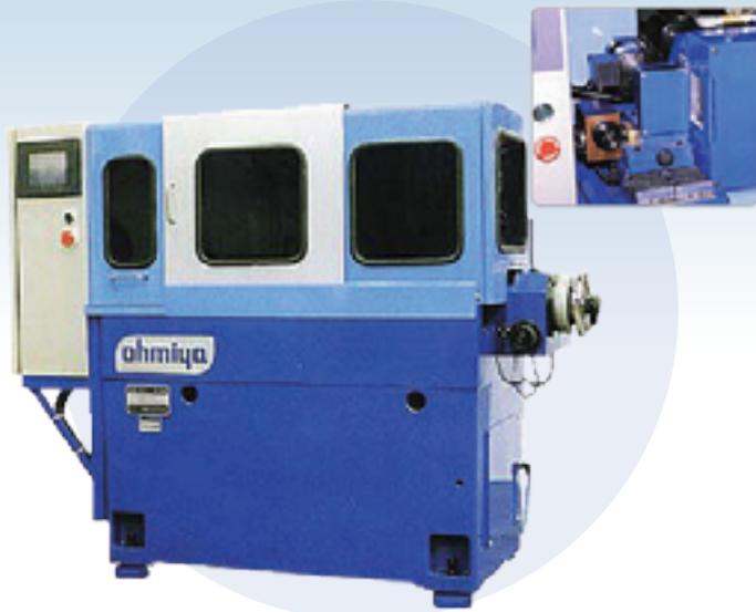
1. 主机上配置了砂轮修整的金刚石滚轮装置。
